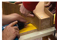
...ausschied, wurde das Biege-MDF mit einem Zweikomponentenkleber aufgeklebt.
