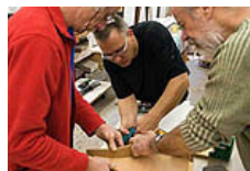
Da einfacher Holzleim zur Befestigung der Hornseitenteile auf dem Boden aufgrund der Beschichtung der Spanplatten...
